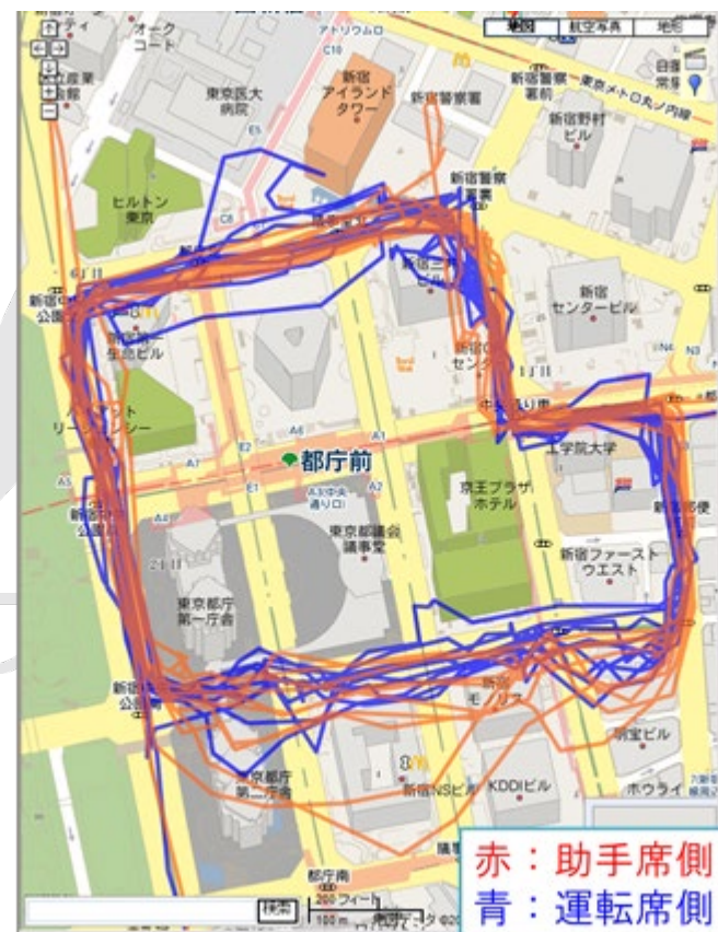
図 21 GPS DATA LOGGER DONGLE を車両に設置しビル街を走行した走行軌跡
